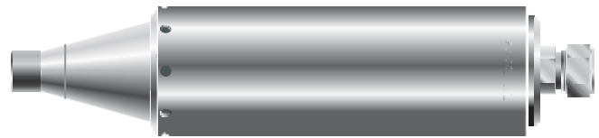
Rys. 1 Impaktor z króćcem izokinetycznym poboru w pozycji pionowej
